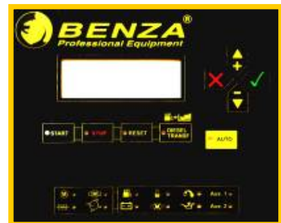
Fig.1 Controlerul digital al generatorului de curent
